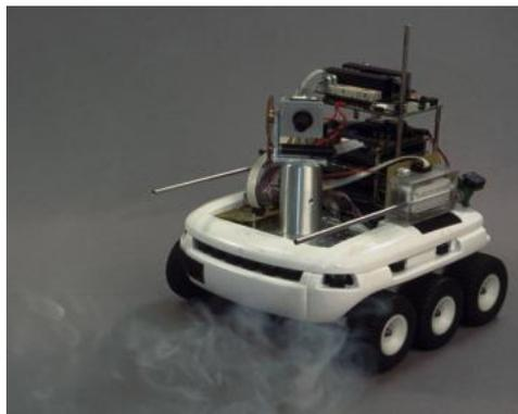
Abbildung 8: Der NOSE Roboter. Die zwei abstehenden Metallzylinder sind die künstlichen Nasenröhren, die die Geruchssensoren eingebaut haben.[12]
